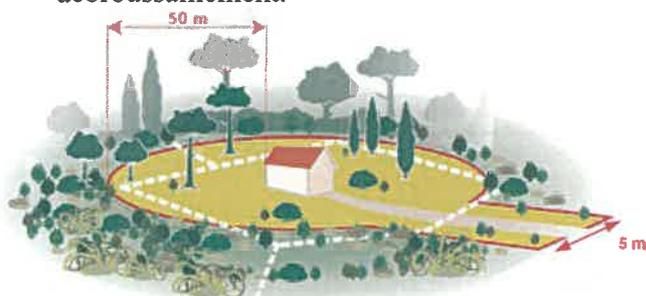
*Schéma type de l'application du débroussaillage réglementaire autour d'une construction et de sa voie d'accès privée*
